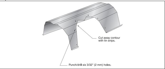
**Step 7.2.5 Reflector Joint Detail**
