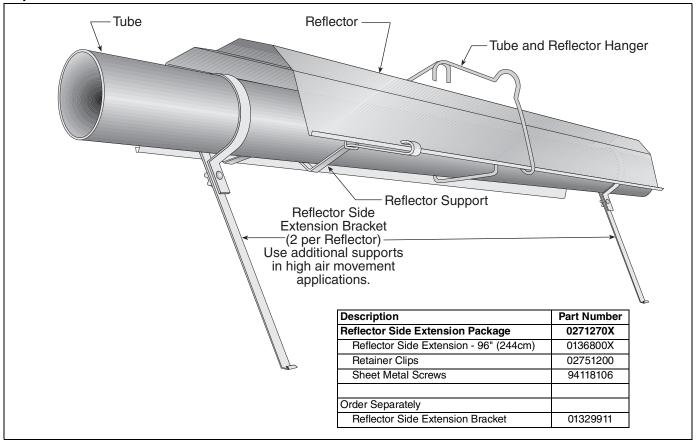
Step 7.3.2 Side Reflector Installation
